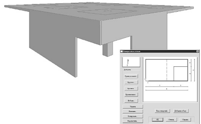
Рис. 10. Задание пересекающихся отверстий в стенах
